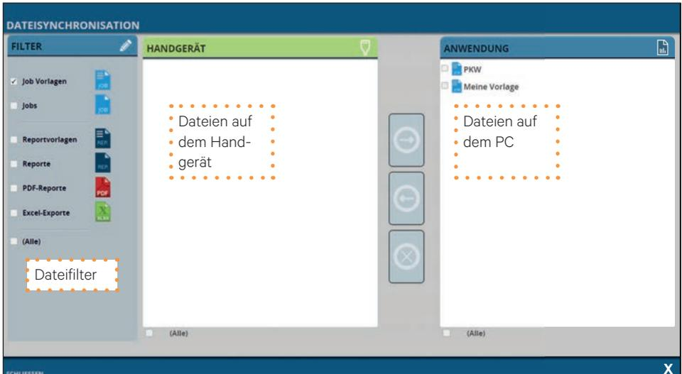
Die Jobvorlage kann nun ausgewählt und mit dem Übertragungs-Button zum Handgerät übertragen werden. Nach erfolgreicher Übertragung der Jobvorlage erscheint diese im Dateifenster „HANDGERÄT“. Das Dialogfenster kann nun geschlossen werden.
