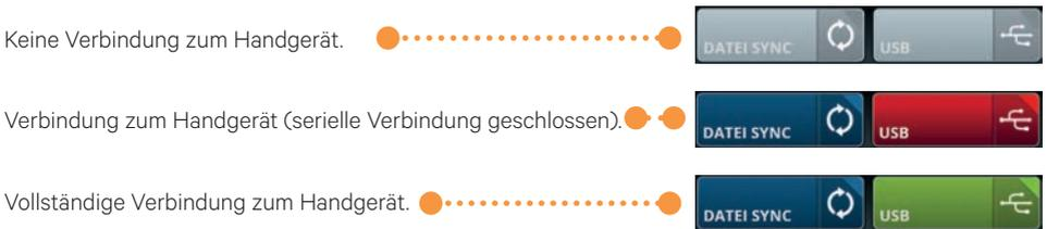
Die serielle Verbindung (Button USB) wird im Regelfall automatisch gesteuert, d. h. die Aktivierung oder Deaktivierung. Man kann die Verbindung aber auch manuell vornehmen. Durch Betätigung des Buttons kann die Verbindung geschlossen oder getrennt werden, falls Verbindungsfehler auftauchen sollten.
